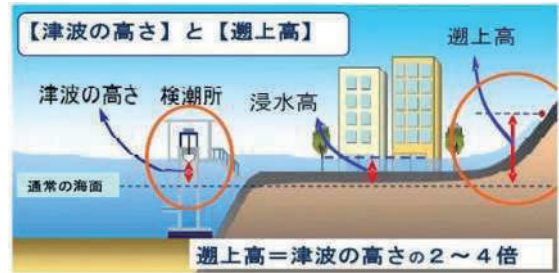
図 1-4 津波の高さ、浸水高、遡上高
