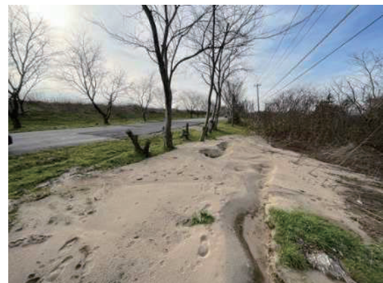
写真-5 噴砂の痕跡(石川県提供)
